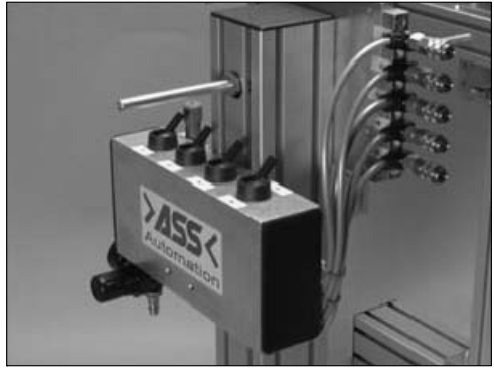
Ventile für die Funktionskontrolle
